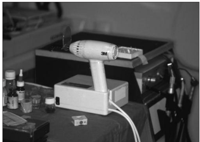
Figura 2. Equipamento odontológico portátil (canetas – baixa e alta rotação e seringa triplíce) e aparelho fotopolimerizador devidamente avaliados
