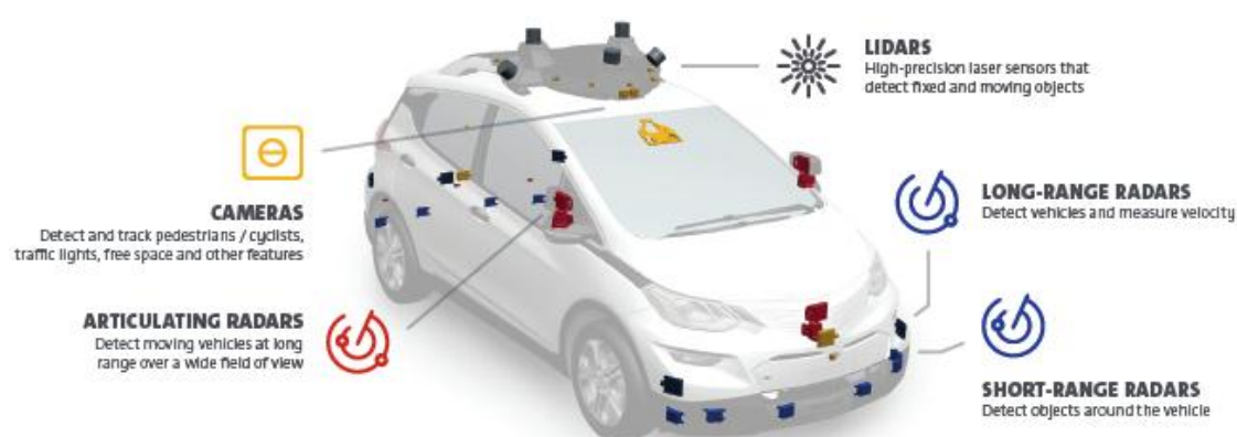
Figura 30 - Sensores, Câmeras e Radares no Chevrolet Cruise AV [6]
