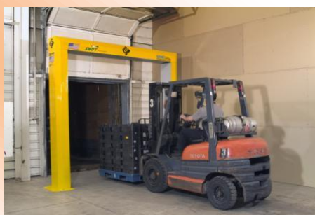
Figura-3. Exemplo de portal RFID/EPC.
