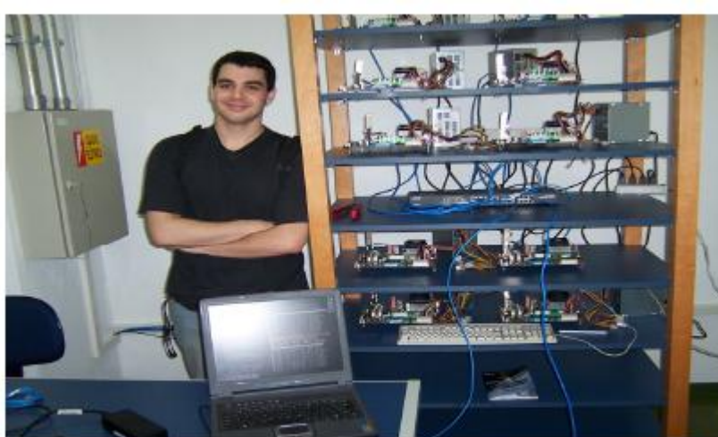
Figura 7. NoteCluster utilizando rack com placas.
