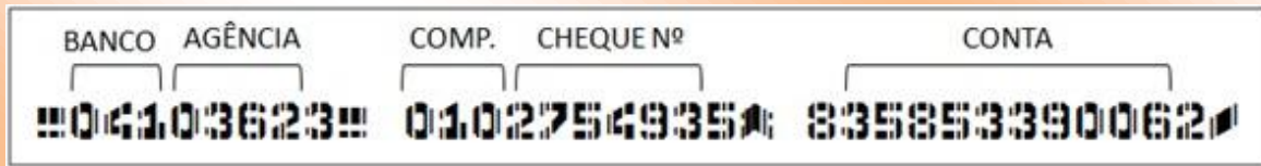
Figura VIII - Exemplo de Caracteres Magnéticos Codificados em 7 barras (CMC7) utilizado em cheque bancário
